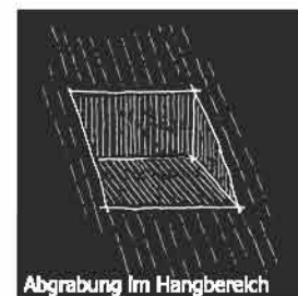
Abgrabung im Hangbereich
